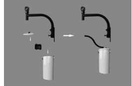
4. Pompa su tankının tabanına konumlandırılmalı su borusu bağlantıları yapılmalı.
